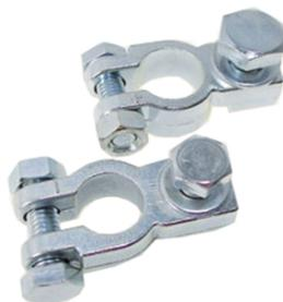
Morsetti batteria negativo in ottone zincato, fissaggio capicorda con bullone a testa esagonale. Negativo perno Ø mm. 8 - Positivo perno Ø mm. 10
