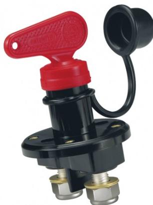
Stacca batteria unipolare con chiave estraibile. 140 Amp servizio continuo, 2000 Amp/3 secondi. Conforme UNI EN 28846. Esecuzione in materiale plastico, contatti in rame argentato. Fissaggio su flangia Ø mm. 64.
