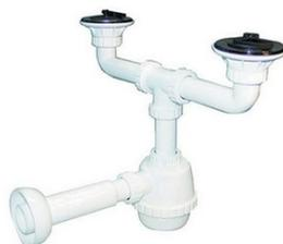
Sifone dotato di un canotto speciale che collega il sifone con ingresso diam. 32, allo scarico a muro con uscita diam. 40. Il corpo sifone rimane solito, con ingressi da diam. 32.
