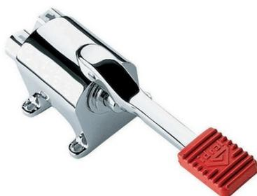
Miscelatore progressivo monopedale esterno per montaggio a pavimento. Con la pressione progressiva della leva, si ottengono in sequenza: acqua fredda, acqua miscelata e acqua calda (a fine corsa).
