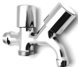
Attacco filettato maschio per lavatrice. Corpo in ottone cromato. Temperatura minima e massima d' esercizio: 0° C, 80° C. Attacchi filettati ISO228 equivalente a (DIN EN ISO 228 e BS EN ISO 228).
