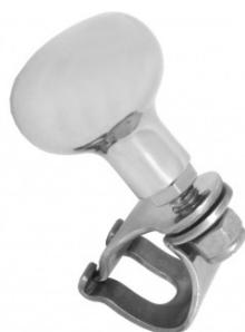
Pomolo girevole in acciaio inox aisi 316 per volante dim. mm. lung. 50 x spessore max. 38 x Ø utilizzabile 20/25
