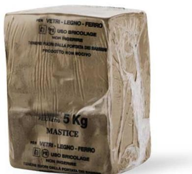
Il prodotto è molto viscoso è costituito da una miscela di oli vegetali, minerali e terre inerti, ad indurimento molto lento dovuto alla polimerizzazione degli oli in esso contenuti, che formano un reticolo plasticato con l'azione dell'aria.
