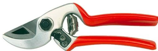
Lunghezza cm. 19 - Peso gr. 170 - Apertura lame mm. 22 - Dx / Sx - Battuta curva - Impugnatura ergonomica - Adatta per mani di piccole dimensioni - Manico in lega di alluminio forgiato anodizzato e rivestito - Controlama in alluminio forgiato - Lama in acciaio forgiato a caldo - Completamente intercambiabile
