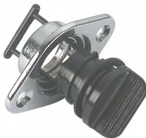
Ombrinale in ottone cromato con tappo in nylon e dispositivo di sicurezza che rende imperdibile il tappo, foro  $\varnothing$  18 mm., esterno  $\varnothing$  23 mm, mm. 34x50.
