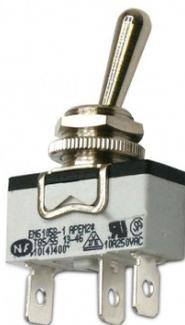
Interruttore corpo in termoindurente, levetta e bussola in ottone nichelato, contatti in argento. Terminali Faston. Capacità 15 Amp. tensione 250V, unipolare. Perno Ø mm. 12. Completi di cappuccio in gomma.
