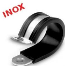
Realizzati con nastro in acciaio inox 304 ricoperto in gomma antivibrante per garantire una maggiore protezione dei supporti contenuti e l'assorbimento delle vibrazioni
