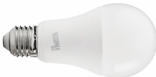
Alimentazione 220-240V / 50 Hz \* Consumo 9W - Resa 60W \* Angolo irradiazione 220° \* Attacco E27 \* Lumen 800 \* Temperatura di colore 2700K \* Durata di vita media 15.000 ore \* Grado di protezione IP 20 \* Dimensioni mm. 110x60
