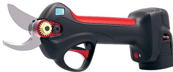
Alimentazione 14,4 Volt \* Voltaggio di lavoro DC. 16 Volt \* Batteria al litio 16,8 Volt 2,5 A/h \* Potenza max 330 Watt \* Diametro di taglio mm. 25 \* Giri motore 22000 \* Tempo di taglio 0.4 \* Tempo di ricarica 1,5-2 ore \* Tempo di lavoro 2-3 ore \* Caricabatteria multiplo \* Dimensioni mm. 290 x 104 x 51 \* Peso gr. 685
