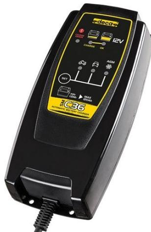
Alimentazione (Volt 50-60Hz AC) 1 Ph x 230 \* Tensione nominale batteria 12V \* Potenza 60 Watt \* Limitazione di tensione 14,4 - 14,7V \* Corrente di carica media 0,8 - 3,6A \* Programmi di carica 4 \* Capacità batteria (Ah min/max) 1,2 - 75 \* Tipo di batteria Pb: WET, GEL, AGM \* Capacità batteria nella carica di mantenimento (Ah max) 120 \* Grado di protezione IP65 \* Dimensioni mm. L202 x P90 x H45 \* Peso kg. 0,55
