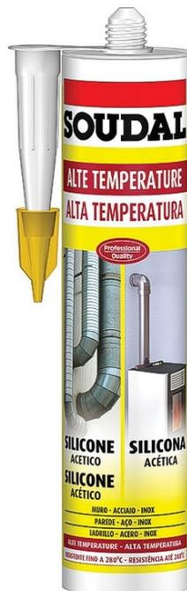
Sigillante siliconico a reticolazione acetica di elevata qualità per elevate temperature. Temperatura di esercizio continuo 250° C e max 300° C, veloce vulcanizzazione e rapido passaggio allo stato fuori impronta. eccellente resistenza agli agenti atmosferici. APPLICAZIONI: Applicazioni in forni, camini o per guarnizioni in canne fumarie in acciaio. Colore ROSSO. Certificazione ISO11600 - UNI 9610/9611
