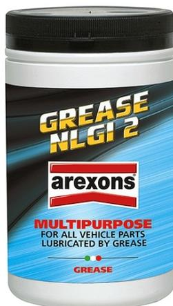
Grasso al litio ad elevata stabilità termica per l'utilizzo con temperature da -20°C a +130°C. L'eccellente stabilità meccanica permette di ridurre al minimo la fuoriuscita d'olio. Alta resistenza all'ossidazione per una migliore durata del grasso. Alta resistenza all'acqua per una superiore tenuta all'azione dilavante dell'acqua. Il prodotto si presenta di colore ambrato e di aspetto liscio ed omogeneo.
