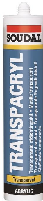
Monocomponente di alta qualità, in dispersione acrilica - Trasparente dopo la completa polimerizzazione - Buona adesione sulla maggior parte delle superfici - Adesione su alluminio anodizzato - Verniciabile dopo la polimerizzazione - Applicazioni: Giunti con movimento fino al 15%, sigillature di riempimento per rotture in calcestruzzo e gesso, giunti di connessione soprattutto per superfici porose, giunti sui davanzali delle finestre tra pavimenti e battiscopa
