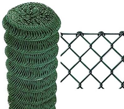
Rete a maglia sciolta \* Copertura Zinco e PVC ecocompatibile Ecoscor \* Maglia quadrata \* Filo mm. 2,60 \* Rotoli con cappucci di protezione alle estremità
