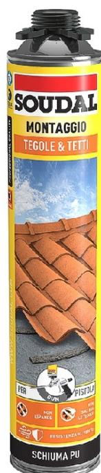
Schiuma poliuretana monocomponente autoespandente per applicazione manuale. Classe infiammabilità B3 (DIN 4102P.2), buona adesione su tutti i materiali eccetto PE/PP, assenza di ritiro dopo l'indurimento, isolamento termico acustico, struttura cellulare aperta e chiusa. APPLICAZIONI: Riempimento di cavità su muratura, isolamento termico in sistemi refrigeranti, montaggio e isolamento di porte e finestre, insonorizzazione. Resa 35-40 Lt. Colore Champagne.
