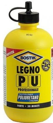
Colla poliuretanica monocomponente dalle eccezionali caratteristiche di tenacità e di forza, di media rapidità. Senza solventi. Particolarmente adatta per utilizzi in esterno. Ideale per incollaggi di quasi tutti i tipi di legno tra loro e derivati, laminati plastici, polistirolo espanso, metalli, cemento e numerose materie plastiche. Resistente all'acqua anche di mare: a norma EN 204 D4.
