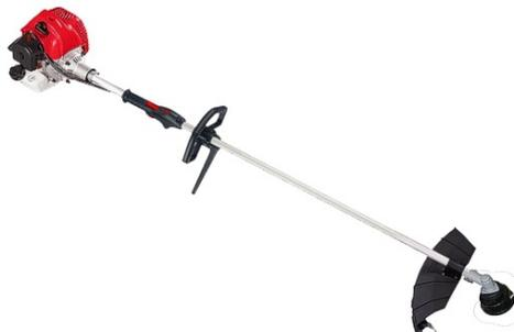
Motore 2 tempi raffreddato ad aria 32,6 cc. potenza 0,9 Kw, regime minimo 2800 rpm, capacità serbatoio 0,9 lt., percentuale miscela 2,5%, lunghezza asta mm. 1520, diametro in alluminio mm. 26, testina femmina mm.10x1,25
