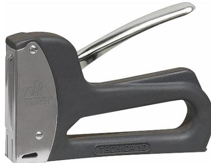
Fissatrice manuale con corpo in ABS , antiurto 20% fibre di vetro e frontale in acciaio cromato - Per lavori di decorazione e fissaggio di tappezzeria, ricoperture di divani e mobili - Per fissare tutti i tipi di carta e stoffa, rivestire sedie e decorare vetrine - Carica da sotto - Blocco maniglia - Peso 330 gr.
