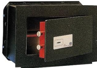
Battente in acciaio da 7 mm. - Serratura con chiave a doppia mappa a 6 leve asimmetriche fornita con 2 chiavi, catenacci diametro 18 mm. - Luce di taglio fra battente e cornice di soli 2/10 di mm., tale da impedire la penetrazione di qualsiasi utensile da scasso - Saldatura continua esterna tale da garantire la massima sicurezza e l'immovibilità nell'accoppiamento frontale-corpo.
